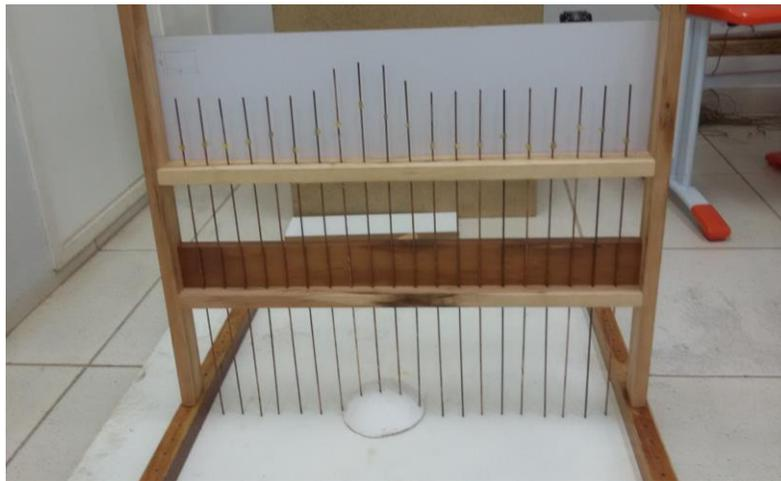
Figura 14 Rugosímetro de varetas validando as elevações do perfil da calota de isopor
