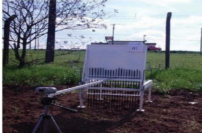
Figura 3 Rugosímetro de varetas apoiado na superfície do solo
