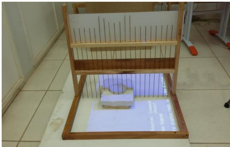
Figura 16 Validação do levantamento do perfil do protótipo da semiesfera de isopor, por meio do rugosímetro de varetas
