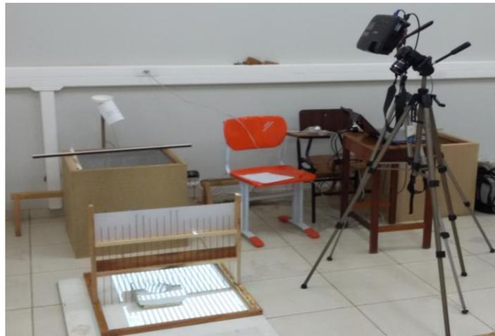
Figura 15 Setup utilizando a técnica do gesso combinada ao rugosímetro de varetas
