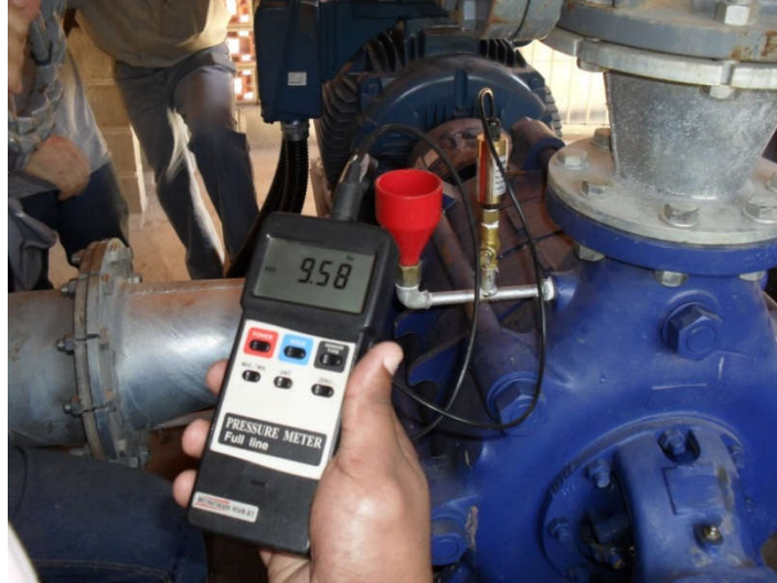
Figura 9 Esquema de instalação do transdutor de pressão relativa na saída da bomba.
