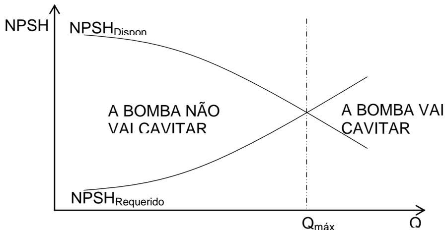
**FIGURA 16.3 - Representação gráfica da variação do NPSH com a Vazão.**
