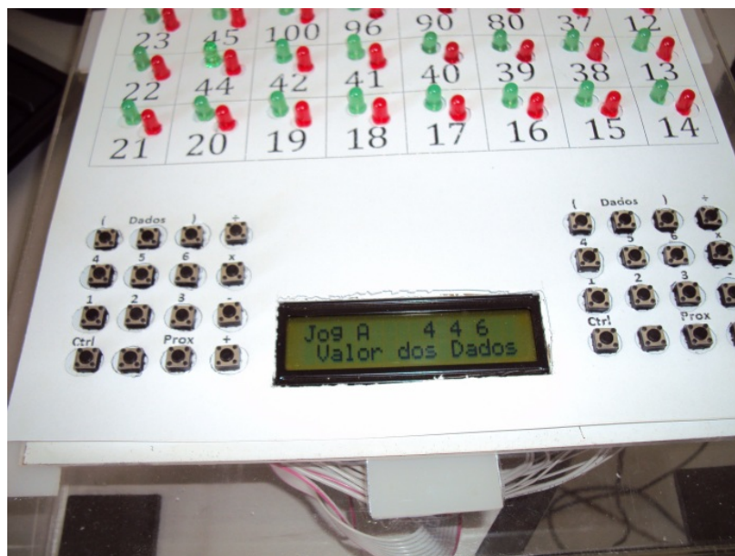
Figura 39 LCD mostrando os três números pseudoaleatórios que representam os dados.
