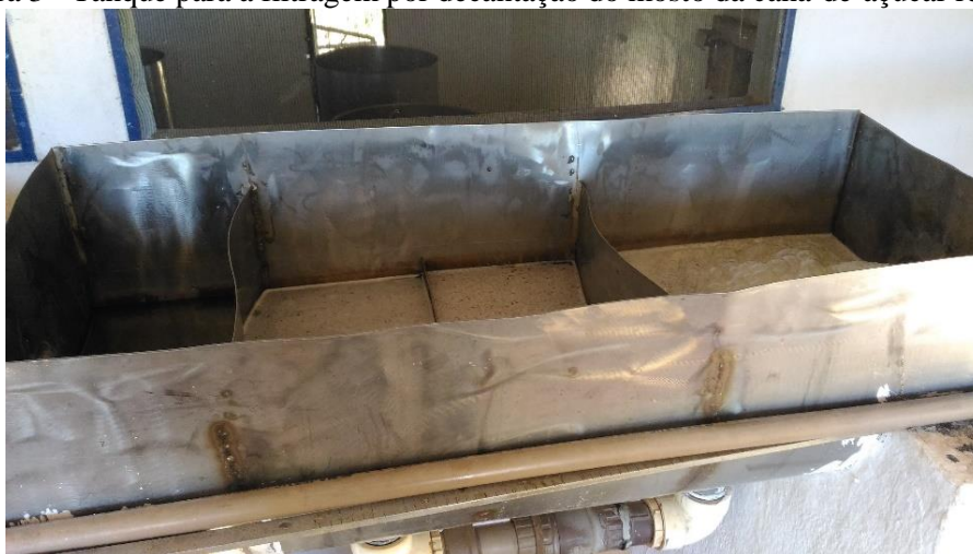
Figura 3 - Tanque para a filtragem por decantação do mosto da cana-de-açúcar recém-moída.
