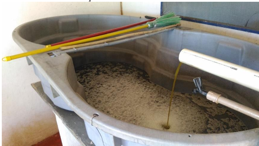
Figura 4 - Tanque reservado para a correção do nível de sacarose, ou graduação BRIX, do mosto da cana-de-açúcar.
