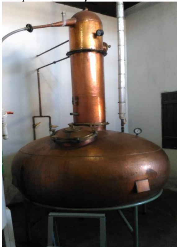
Figura 12 - Alambique de cobre por onde a cachaça é destilada.
