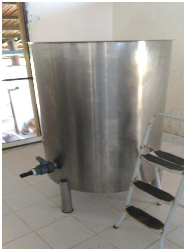
Figura 5 – Tanques de aço inox por onde é realizada a fermentação do mosto da cana-de-açúcar.
