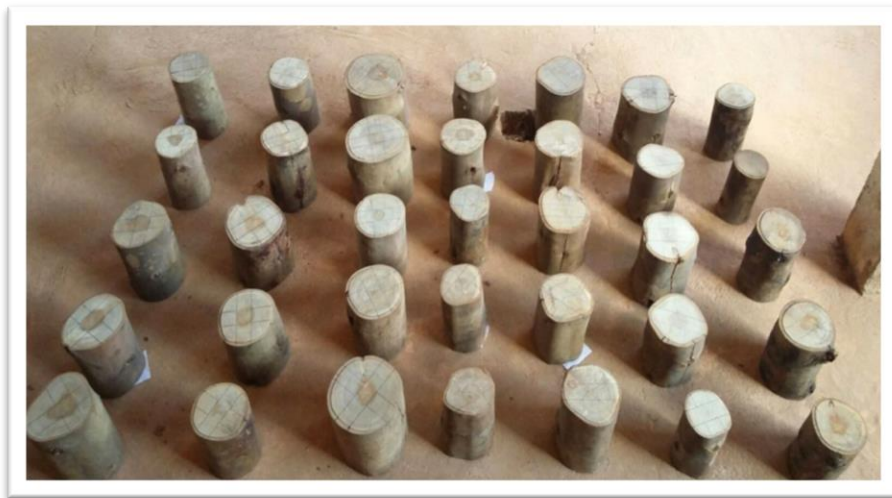
Figura 1 – Toretos retirados nas árvores na altura do DAP.
