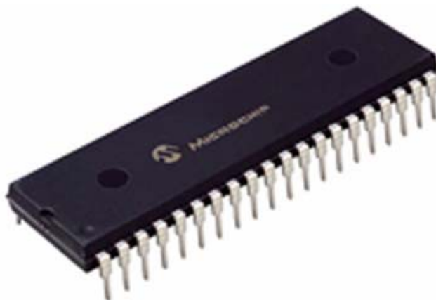
Figura 4 PIC 18F45xx encapsulamento DIP Fonte: MICROCHIP (2012).
