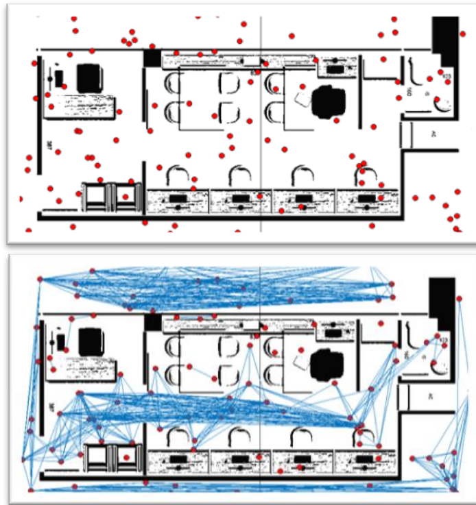
Figura 6 - Estágios 1 e 2 para a geração do caminho mínimo no cenário teste, utilizando o algoritmo MRP.
