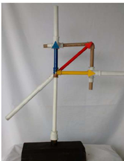
Figura 6 - “Decompositor vetorial”: material manipulativo que simula a decomposição de um vetor em componentes ortogonais. Fonte próprio autor.
