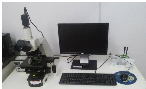
Figura 3 - Microscópio acoplado à câmera de vídeo capaz de gerar imagens por meio das quais os parâmetros de motilidade são calculados pelo CASA.
