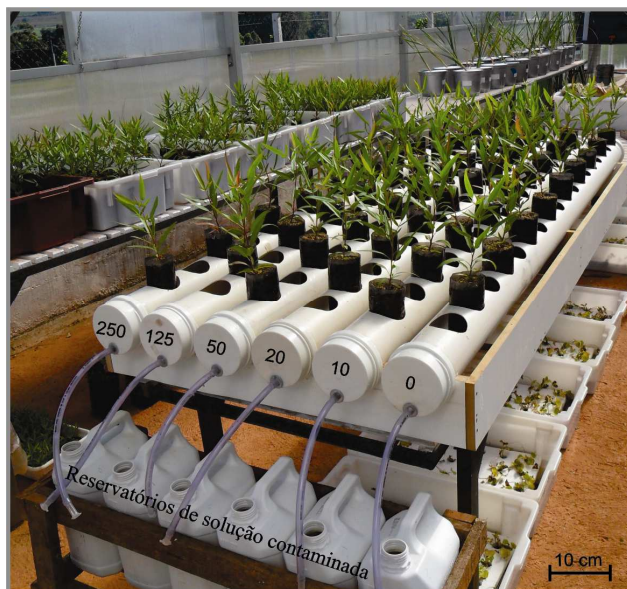
Figura 2 Sistema de coleta da solução de Hoagland contaminada com cádmio dos diferentes tratamentos utilizando canos PVC.
