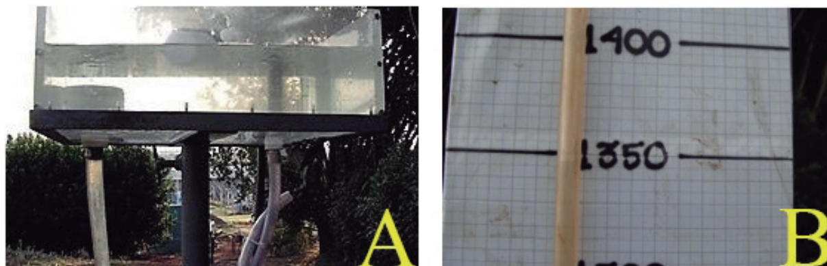
FIGURA 1 - Caixa d'água com nível constante e altura variável do reservatório (A), e piezômetro graduado para leitura das pressões (B).
