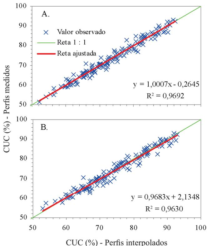
**Figura 4.** Coeficientes de Uniformidade de Christiansen (CUC) simulados com perfis radiais interpolados entre pressões de serviço (A) ou entre bocais (B) versus simulados com perfis radiais medidos
