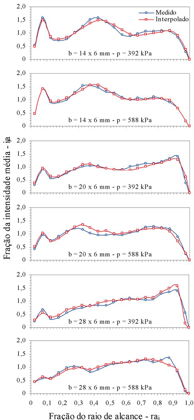
Figura 1. Perfis radiais adimensionais observados e gerados por interpolação entre pressões de serviço
