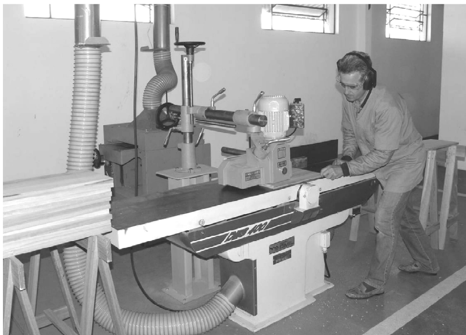
Figura 2 – Aplainamento dos corpos-de-prova utilizando alimentador de avanço mecânico.
