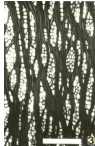
Figura 3 Anacardium microcarpum - corte tangencial mostrando muitos raios extremamente baixos (faixas brancas) e fibras (partes negras). Escala de 200 \mu\text{m}
