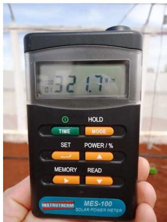
Figura 9 Medidor de Energia Solar portátil
