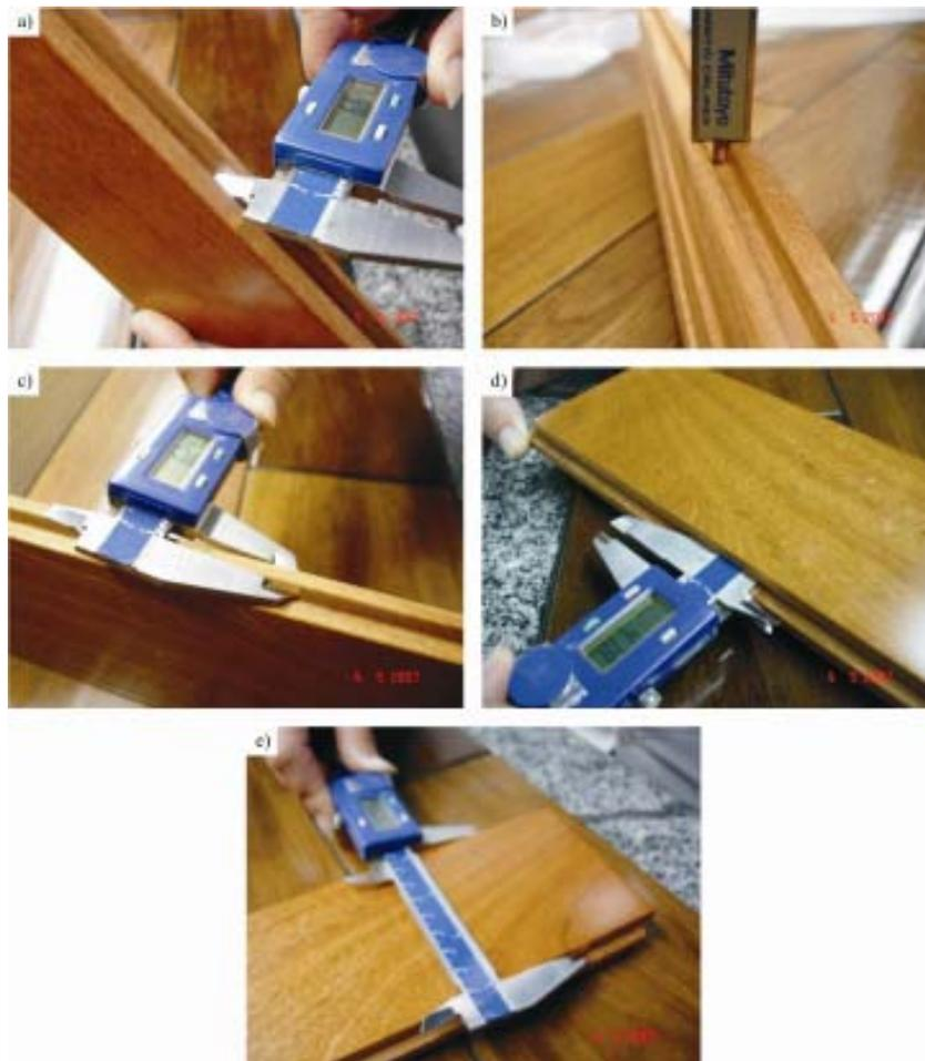
**Figura 1** – Medições realizadas nos pisos: a) Espessura da fêmea; b) Profundidade da fêmea; c) Espessura do macho; d) Comprimento do macho; e) Largura do piso.
