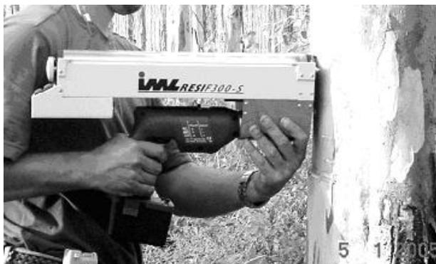
**Figura 2** – Utilização do resistógrafo na estimativa da densidade básica da madeira de *Eucalyptus urograndis*.
