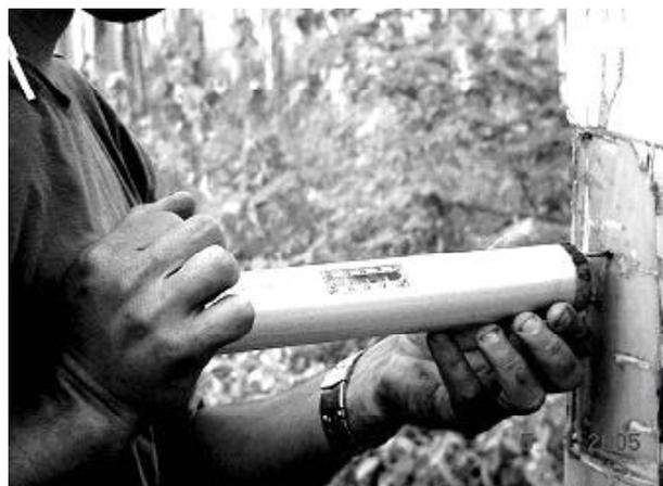
**Figura 1** – Medição da profundidade de penetração do pino de pilodyn utilizado na estimativa da densidade básica em *Eucalyptus urograndis*.
