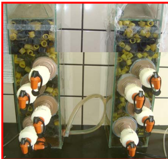
Figura 4 Biofiltros contendo meio suporte conduíte inoculado com os fungos Penicillium citrinum e Aspergillus brasiliensis isolados de regiões contaminadas com elementos-traço
