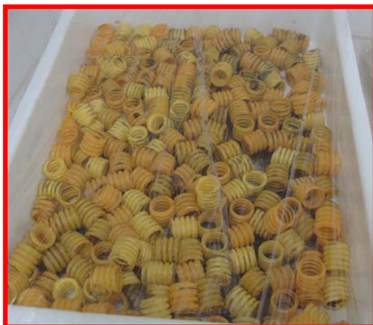
Figura 2 Bandeja contendo o meio suporte conduíte inoculado com os esporos fúngicos em meio ágar extrato de malte ainda fundidos, encoberta por plástico filme e incubada, a 25^\circ\text{C}
