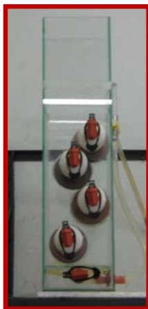
Figura 1 Biofiltro de vidro utilizado no teste de remoção de elementos-traço
