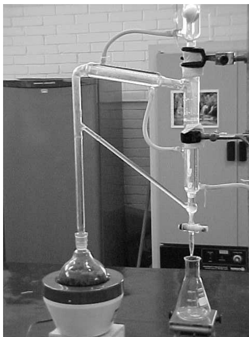
FIGURA 4 Aparelho extrator de óleos Clevenger modificado.
