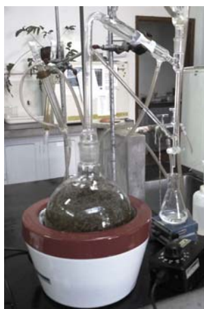
Figura 10 Aparelho de Clevenger modificado, utilizado na extração do óleo essencial de cravo-da-índia ( S. aromaticum )
