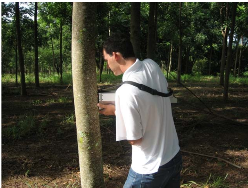
FIGURA 6 Resistógrafo para obtenção de dados de resistência mecânica a penetração da broca de sondagem na madeira de Toona ciliata .
