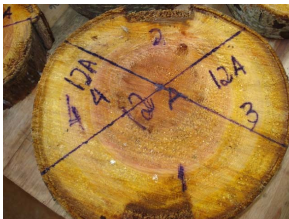
FIGURA 8 Disco retirado a 1.30m do solo para avaliação da densidade básica
