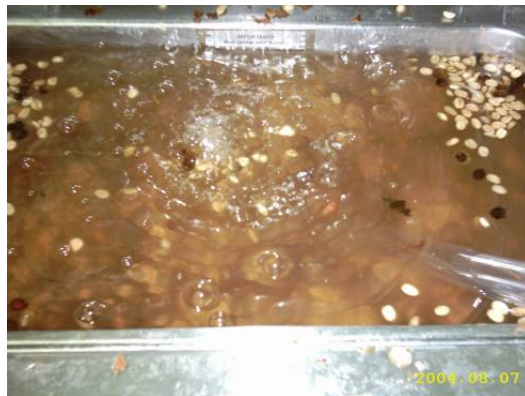
FIGURA 7 Tratamento do café em cuba ultra-sônica com borbulhamento de ozônio.
