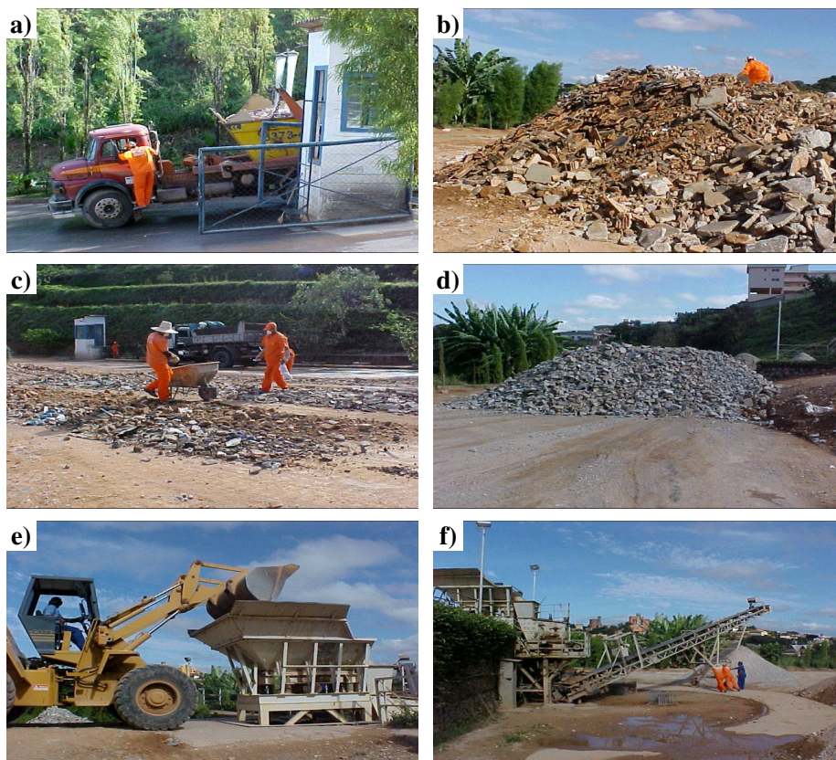
FIGURA 12 – Etapas do processo de reciclagem de entulho
