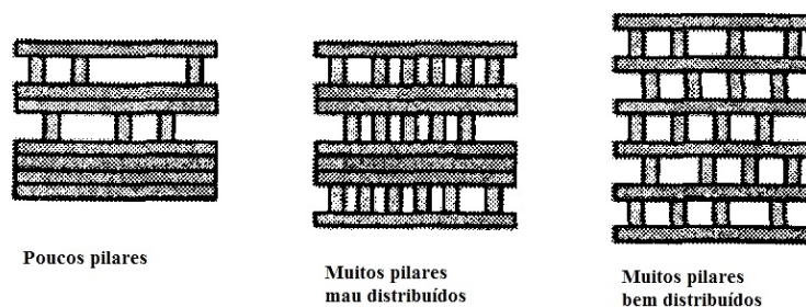
Figura 16 Esquema da estrutura de argilas pilarizadas com diferentes quantidades e distribuições de pilares
