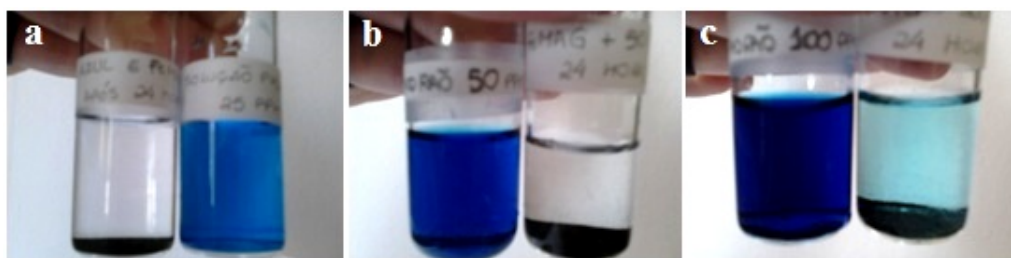
Figura 17 Imagens das soluções após contato com FeMAG por 24 horas. Comparação com as soluções padrão: (a) 25 ppm, (b) 50 ppm e (c) 100 ppm
