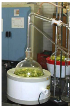
Figura 11 Processo de extração de óleo essencial (hidrodestilação)
