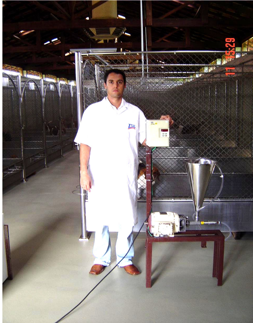
FIGURA 5 - Equipamento de bombeamento desenvolvido pelo autor utilizado para introdução do alimento pelo tubo gastro-esofágico.
