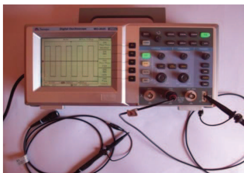
Figura 26 Osciloscópio digital utilizado neste experimento
