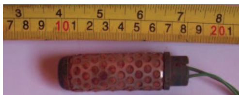
Figura 10 Sensor de matriz granular Watermark ®
