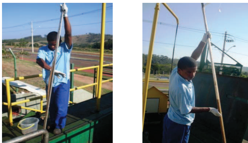
Figura 6 Coleta de lodo com amostrador desenvolvido na UFLA
