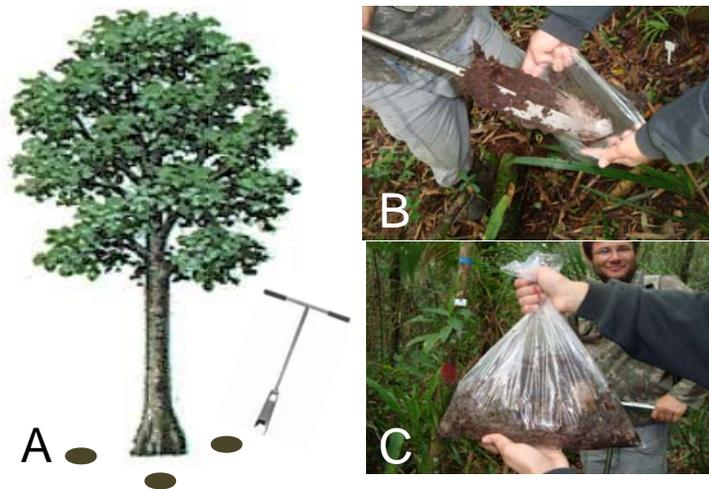
Figura 3 Método de coleta das amostras de solo. A. Forma de coleta das 3 subamostras de solo sob a copa das árvores com o detalhe do trado. B. Detalhe do trado contendo uma subamostra de solo coletado. C. Saco plástico contendo amostra composta (3 subamostras misturadas)
