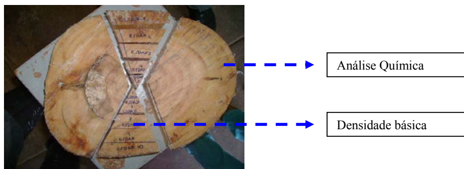
FIGURA 2 Retirada dos corpos-de-prova para análise química e de densidade básica.
