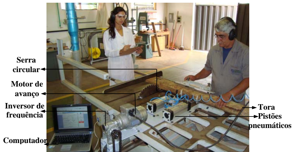
FIGURA 3 Serra circular de carrinho (DCF/UFLA) com avanço mecânico automático da mesa.
