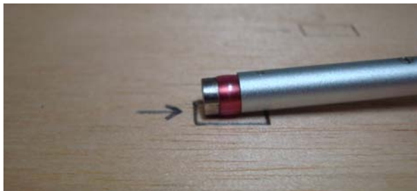
FIGURA 7 Indicação do local e sentido de medição da rugosidade.
