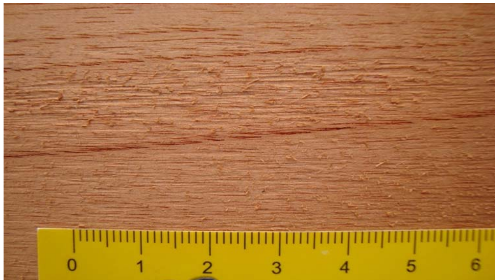
FIGURA 3A Superfície com arrepimento forte e arrancamento leve, qualificada pela nota 3
