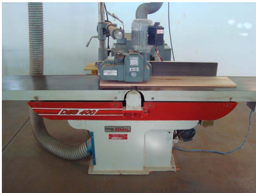
FIGURA 5 Ensaio de usinagem realizado na plaina desempenadeira com controle da velocidade de avanço.
