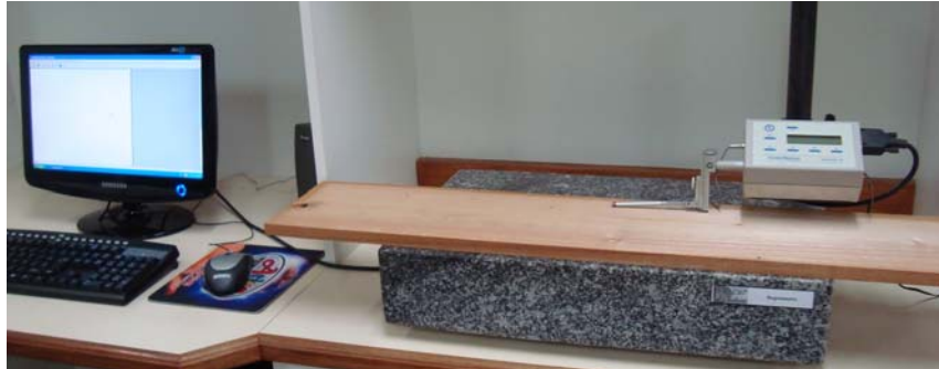
FIGURA 6 Análise de rugosidade realizada por meio de rugosímetro de arraste.
