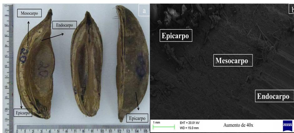
Figura 2 Fragmentos do coco babaçu (a) e imagem obtida pela microscopia eletrônica de varredura (MEV) (b).
