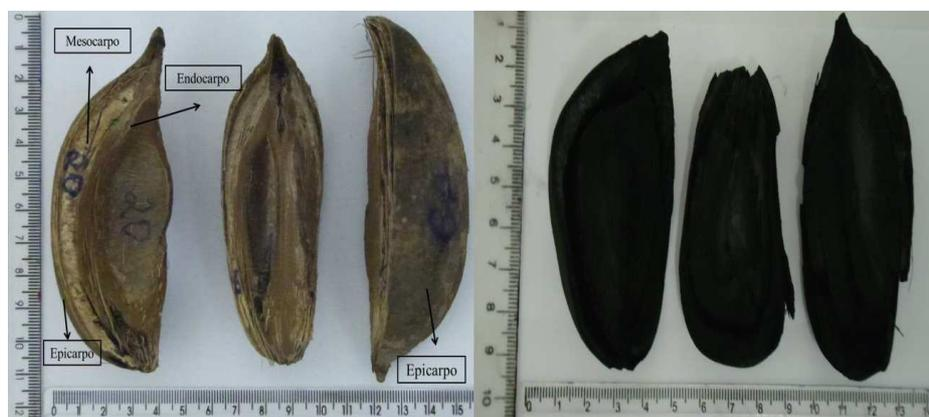
Figura 1. Fragmentos do coco babaçu utilizados na carbonização e o carvão vegetal obtido na temperatura final de 450°C.
