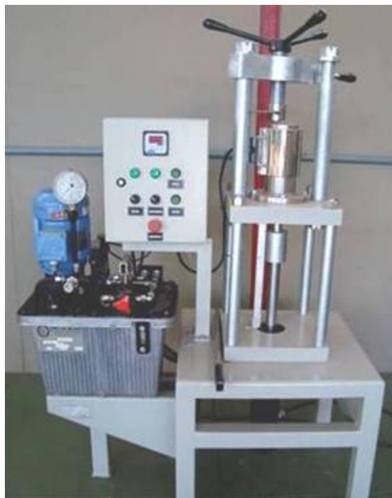
FIGURA 2 Briquetadeira hidráulica para laboratório.
