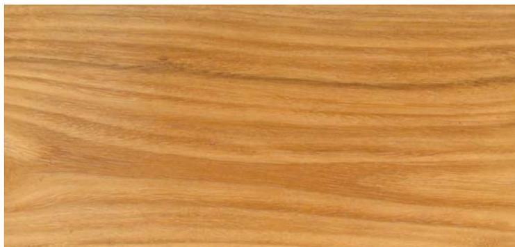
FIGURA 11 Superfície de *Eucalyptus microcorys* F. Muell com acabamento para o ensaio de atrito.
