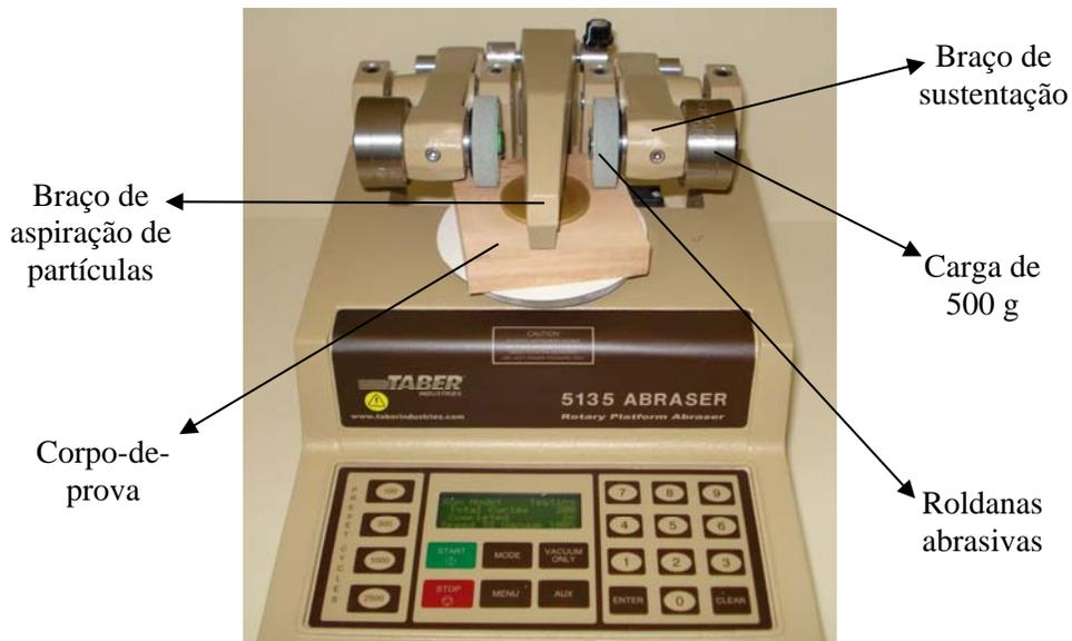
FIGURA 14 Equipamento utilizado nos ensaios de resistência à abrasão da madeira.
