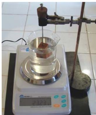
FIGURA 2 Obtenção do volume verde dos corpos-de-prova pelo método de imersão em água.
