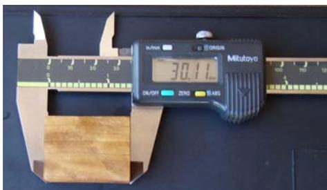
FIGURA 1 Paquímetro utilizado para mensurar as distâncias lineares dos corpos-de-prova.
