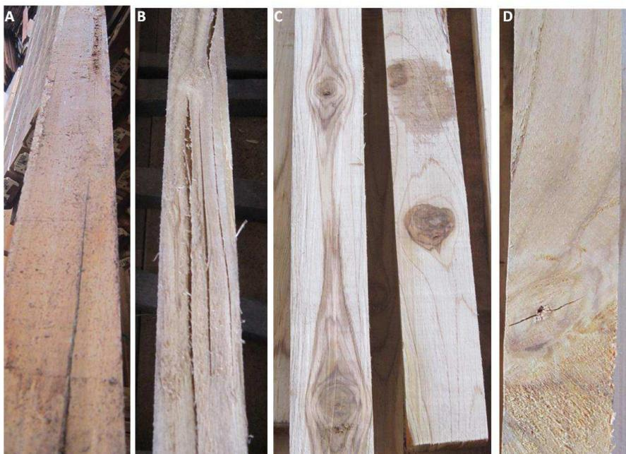
Figura 24 Defeitos na madeira após a secagem convencional em estufa industrial. A: rachadura superfície; B: rachaduras de superfícies; C: nós; D: rachadura de nó
