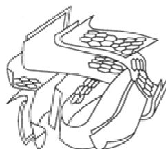
FIGURA 1 – Representação esquemática da estrutura do CA (Adaptado de Rodríguez-Reinoso, 1998).
