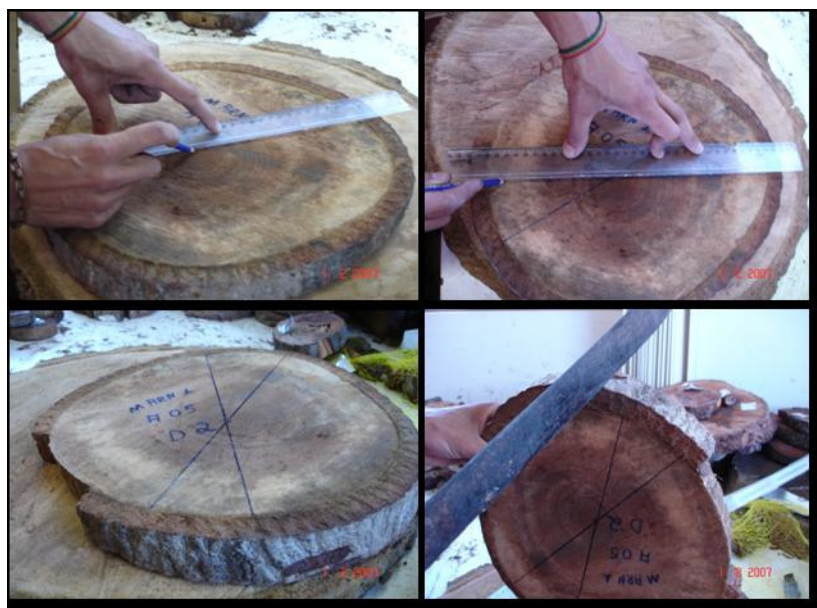
FIGURA 8 Marcação das cunhas opostas e retirada da casca para a determinação da densidade.
