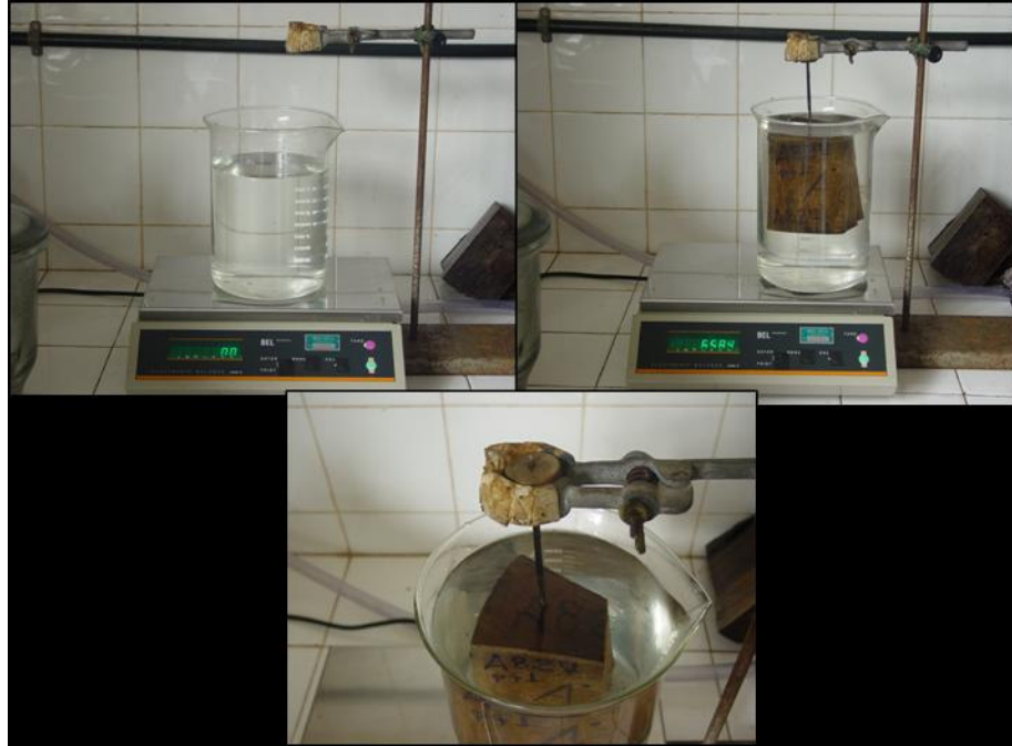
FIGURA 10 Medição do volume por meio do princípio de Arquimedes.
