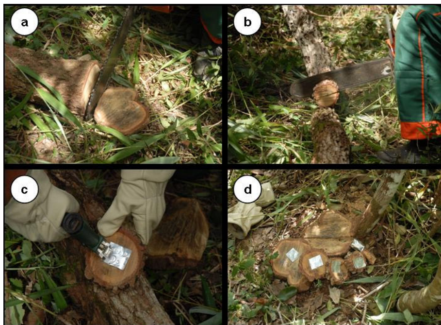
FIGURA 7 Retirada dos discos (a e b), e identificação dos mesmos conforme o local, a árvore e sua posição nela (c e d).
