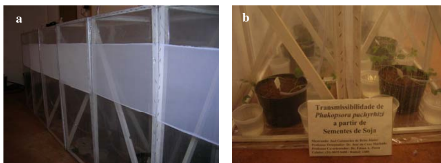
FIGURA 1. Fotografias mostrando estruturas de madeira revestidas com plástico transparente, utilizadas para cobertura dos vasos. (a) Uma das faces opostas da caixa protetora com espaço preenchido com tecido, tipo “tela antiafídica”, permitindo ventilação junto às plantas; (b) Vasos, no interior das caixas de proteção, tendo ao seu redor quatro potes com água para a elevação da umidade relativa do ar.
