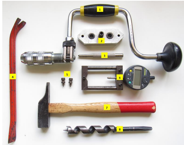
Figura 12 - Detalhamento do equipamento utilizado para as medições das DTS.
