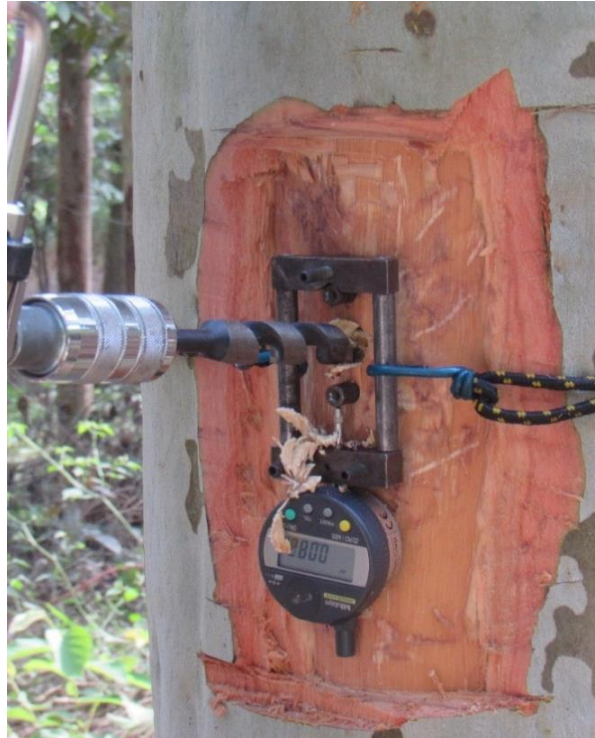
Figura 3 - Medição das DRL em tábuas de árvores de Corymbia citriodora .
