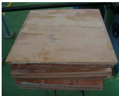
FIGURA 11. Painéis após prensagem.
