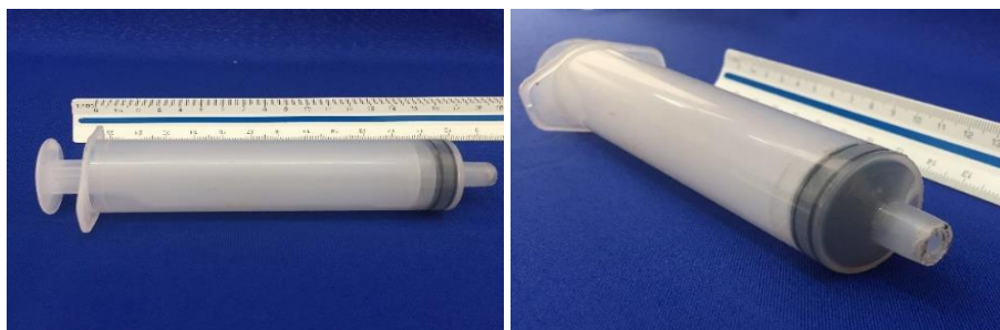
Figura 7 – Seringa utilizada como extrusora manual para a confecção dos pellets de fertilizante nitrogenado.
