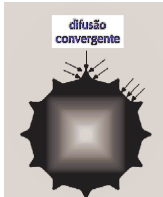
FIGURA 33 Um exemplo de difusão convergente de material em torno das extremidades e a difusão não convergente nas faces.
