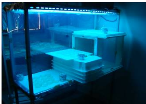
Figura 3 Esquema do ensaio para avaliar a sensibilidade dos conídios de Trichoderma e de Clonostachys rosea à radiação UV-B
