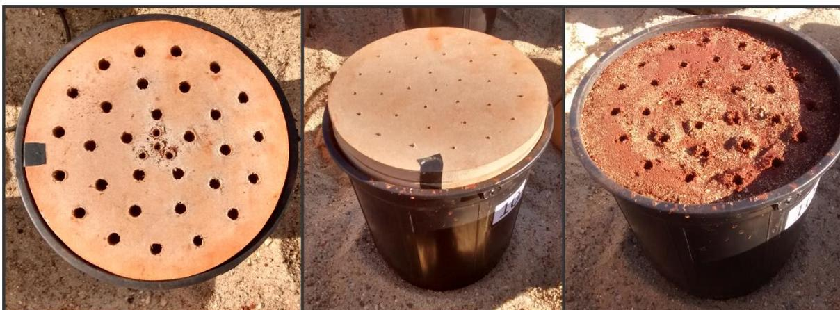
O conteúdo de água dos vasos foram mensurados diariamente ao longo de todo o período experimental, a profundidade de 0 a 10 cm, por meio de sensores de umidade do equipamento ML2 (Theta probe - Delta T, FIGURA 4). Os vasos foram irrigados sempre que necessário, de forma manual com o auxílio de um Becker graduado, para manutenção de 65% de água disponível, na porção de solo amostrada.
