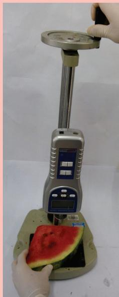
*Figura 4 - Penetrômetro*
