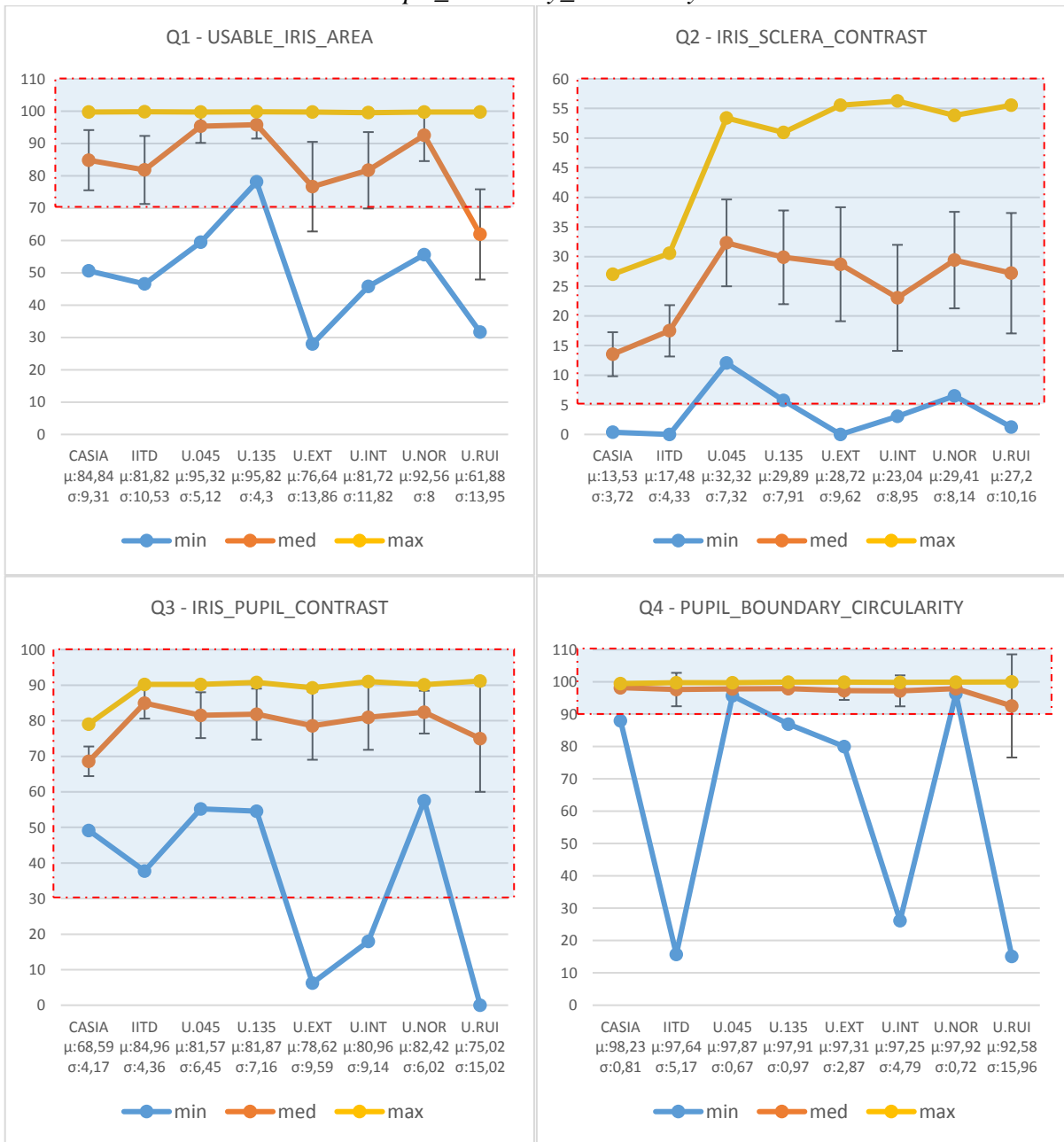
Figura 31 – Valores mínimo, médio, máximo e desvio padrão para as métricas: (Q1) Usable_Iris_Area , (Q2) Iris_Sclera_Contrast , (Q3) Iris_Pupil_Contrast e (Q4) Pupil_Boundary_Circularity
