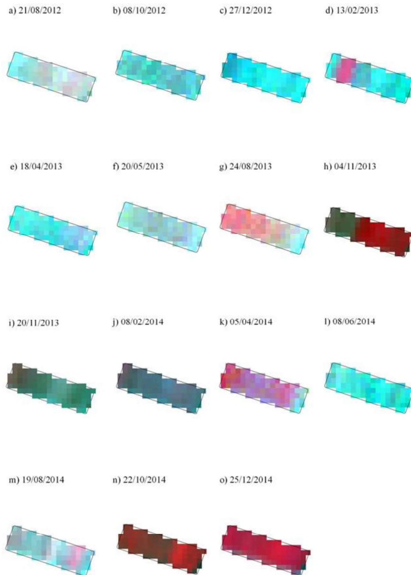
Figura 9. Mapas de composição colorida falsa-cor RGB obtidas a partir de imagens do sensor Landsat-7/ETM+ das bandas 432 e do sensor Landsat-8/OLI-TIRS das bandas 543 de área cultivada sob sistema de irrigação por gotejamento.
