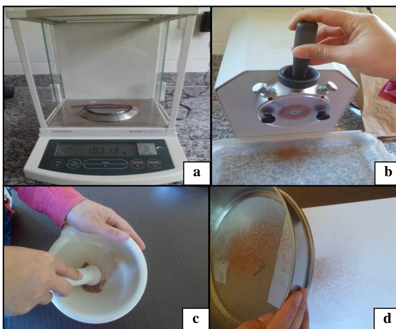
Figura 4 Procedimentos para obtenção da massa seca e do material para análise do teor de carbono: a) Pesagem da amostra; b) Moagem da amostra; c) Maceração da amostra; d) Obtenção do pó de madeira
