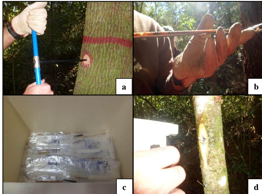
Figura 2 Etapas da coleta das amostras: a) Retirada da amostra com o trado de incremento; b) Amostra coletada; c) Amostras acondicionadas em sacos plásticos; d) Aplicação de calda bordalesa no orifício do tronco
